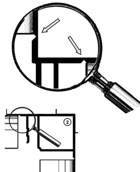
**Etape 3 :** Insérer le profilé 1 dans le profilé 2 à l'aide d'un maillet, jusqu'en butée.
