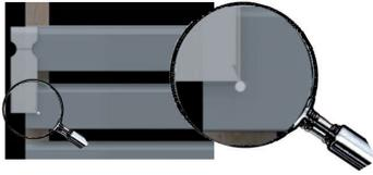
**Etape 2 :** Positionner le cloueur dans le repère du gabarit, aligné au-dessus de la pointe et pointer.
