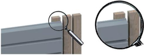
**Etape 2 :** Fixer le profilé d'aboutage sur le second tasseau, en laissant au minimum 5 mm de jeu de dilatation entre le profilés et les profils.
