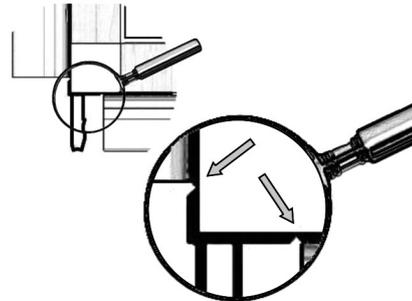
**Etape 3 :** Insérer le profilé ② dans le profilé ① à l'aide d'un maillet, jusqu'en butée.
