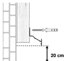
**Etape 2 :** Poursuivre la pose en fixant les profils (cf paragraphe relative à la fixation des profils).
