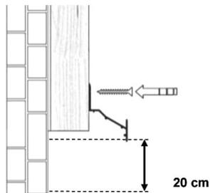
**Etape 2 :** Poursuivre la pose en fixant les profils (cf paragraphe relatif à la fixation des profils). Prévoir une coupe d'onglet à 30° à la base de chacun des profils.
