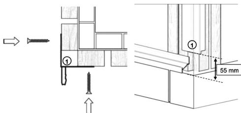
**Etape 2 :** Fixer les profils en prenant soin de les aligner sur le repère visible sur le profilé ①
