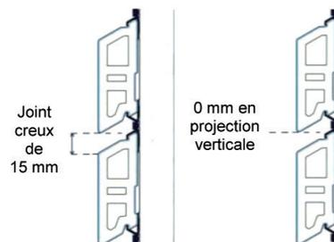
**Etape 1 :** positionner le profil dans les clips en respectant le sens de pose.
