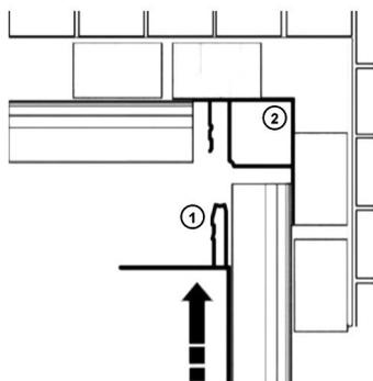
**Etape 4 :** Supprimer l'éventuel glissement entre les deux profilés en vissant une vis autoforeuse en inox (soit à l'extérieur - cf schéma "a.", soit à l'intérieur - cf schéma "b."). Une seule vis est nécessaire par angle.
