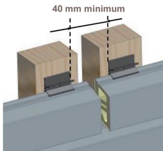
**Etape 2 :** Positionner d'abord la partie supérieure du couvre joint, puis clipser la partie inférieure en exerçant un effort horizontal.
