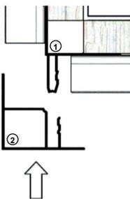
**Etape 4 :** Supprimer l'éventuel glissement entre les deux profilés en vissant une vis autoforeuse en inox (soit à l'extérieur - cf schéma "a.", soit à l'intérieur - cf schéma "b."). Une seule vis est nécessaire par angle.
